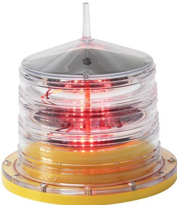
Luz de obstrucción solar autónoma de 32 candelas (en modo de destello), ofrece 30 días de autonomía en días nublados, la fotocelda enciende y apaga la luz del crepúsculo al amanecer automáticamente, el interruptor ajusta el modo de trabajo de luz constante o intermitente según sea necesario, cuenta con un grado de protección IP68 y remate en forma de aguja para protección contra aves.
